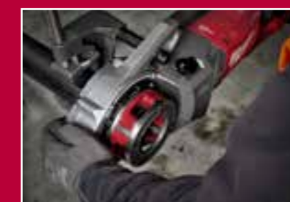
L'impugnatura laterale consente massimo controllo durante il processo di filettatura
