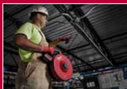
Alimentazione e ritrazione automatica della sonda
